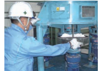
②供給機構部取り外し作業 ストックタンクより供給機構部の取り外しを行っています。
