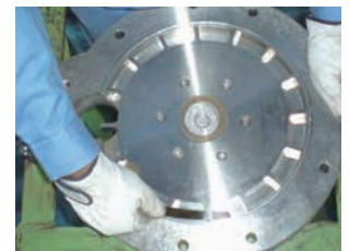
⑥クリアランス測定作業 クリアランスの測定を行い適正值に調整を行っています。
