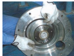
⑤部品交換作業 摩耗した消耗部品の交換を行っています。
