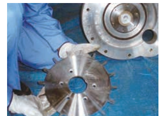
④供給盤取り外し作業 供給盤を取り外し摩耗具合の確認を行っています。
